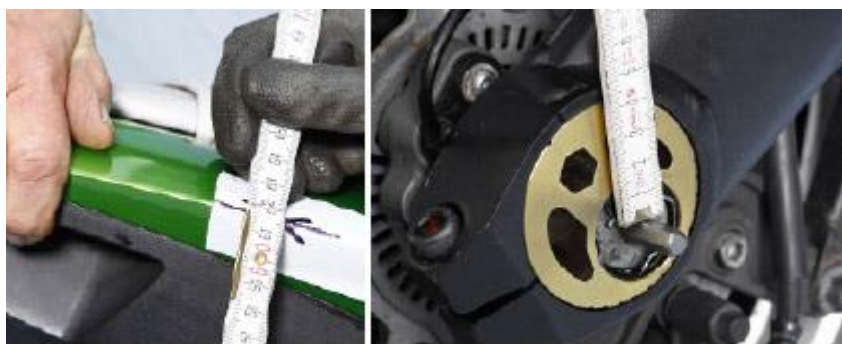
Messpunkte z. B. mit Klebeband und Bit festlegen
