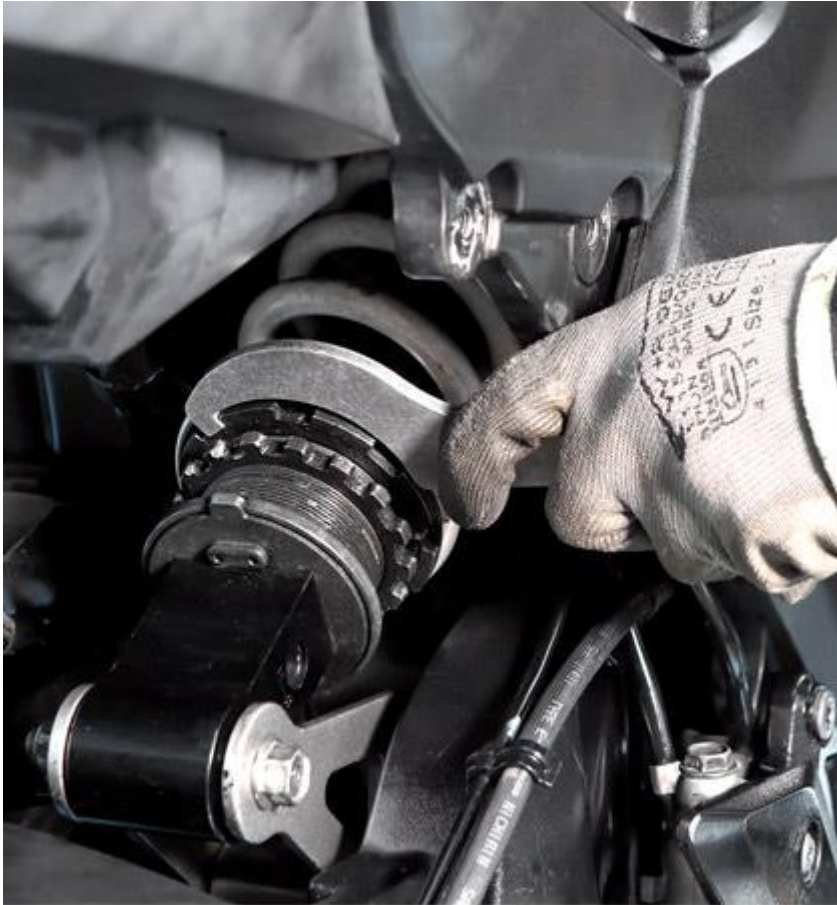
Vorspannung am Federbein per Nutmutter: ziemliches Gefrickel
